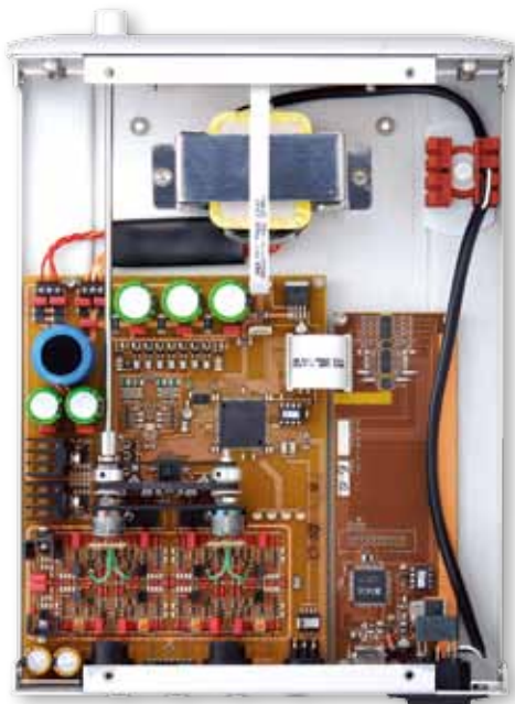
←QA-9的類比與數位電路放在一塊，USB電路獨立一塊，可以清楚看到分砌式類比電路、皮帶、AD轉換晶片與FPGA晶片。
